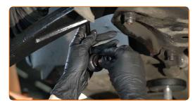
Ziehen Sie das Befestigungselement an, das die Druckstange mit dem Stabilisator verbindet. Verwenden Sie Stecknuss Nr. 17. Verwenden Sie einen Drehmomentschlüssel. Ziehen Sie ihn mit 36 Nm Drehmoment fest.
