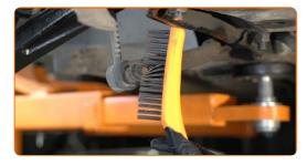
Schrauben Sie das Befestigungselement heraus, das die Druckstange mit dem Stabilisator verbindet. Verwenden Sie Ring-Gabelschlüssel Nr. 16. Verwenden Sie Stecknuss Nr. 15. Verwenden Sie einen Ratschenschlüssel.
