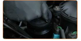
Überprüfen Sie den Ölstand mit Hilfes des Ölmessstabs. Füllen Sie Öl nach, falls nötig.
