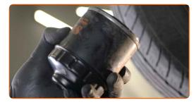
Reinigen Sie die Ölfilteraufnahme. Verwenden Sie Allzweckreinigungsspray.
