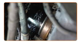
Ziehen Sie die Befestigungselemente des Ölfilter fest. Denken Sie daran, das empfohlene Anzugsdrehmoment einzuhalten. Verwenden Sie Steckschlüssel 76-14F. Verwenden Sie einen Drehmomentschlüssel. Ziehen Sie ihn mit 19 Nm Drehmoment fest.
