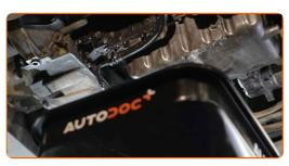
Reinigen Sie den Bereich um die Ablassöffnung der Ölwanne. Benutzen Sie eine Drahtbürste. Verwenden Sie Allzweckreinigungsspray.
