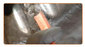
Drehen Sie die Ablassschraube heraus. Verwenden Sie Stecknuss Nr. 24. Verwenden Sie einen Ratschenschlüssel.
