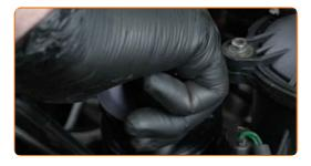
Befestigen Sie den Deckel des Öleinfüllstutzens.
