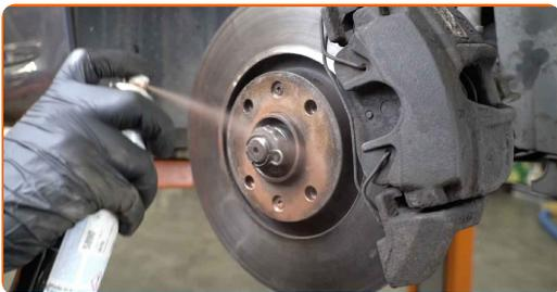
**48** Die Bremsscheibenoberfläche reinigen. Benutzen Sie einen Bremsenreiniger.
