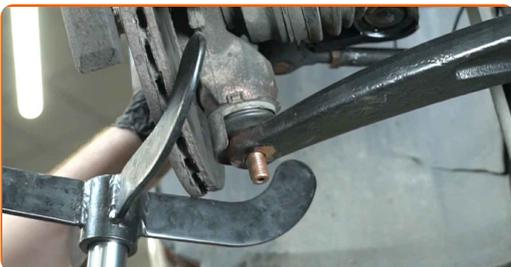
**36** Entfernen Sie den Träger unter dem Achsschenkel.
