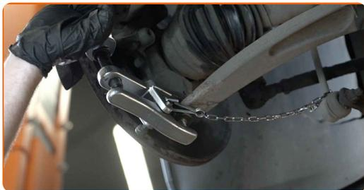
**13** Stützen Sie die Achsschenkel auf. Benutzen Sie einen hydraulischen Getriebeheber.
