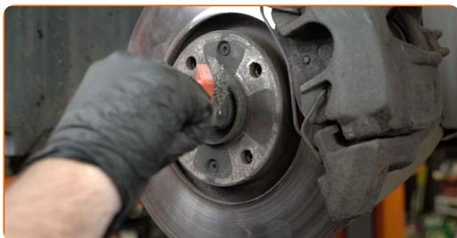
**7** Entfernen Sie den Splint der Mutter der Antriebswelle. Verwenden Sie einen Splintentreiber.
