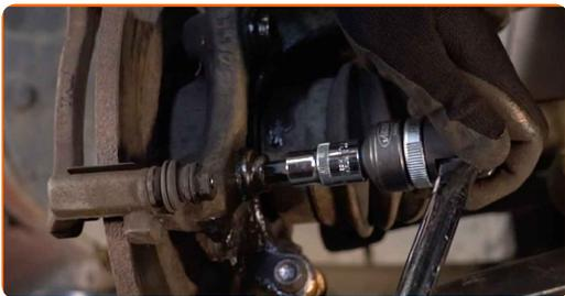
**14** Entfernen Sie die Sattelhalterung.
