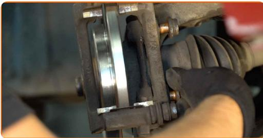
**23** Befestigen Sie die Bremssattelhalterung. Verwenden Sie den Torx T55. Verwenden Sie einen Drehmomentschlüssel. Ziehen Sie ihn mit 105 Nm Drehmoment fest.
