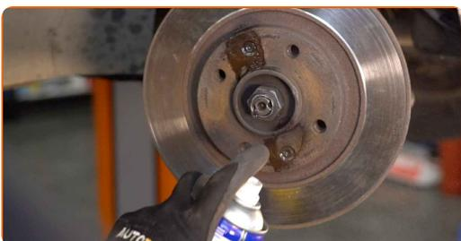
**16** Lösen Sie die Befestigung der Bremsscheibe. Verwenden Sie den Torx T30. Verwenden Sie einen Schlagschrauber.
