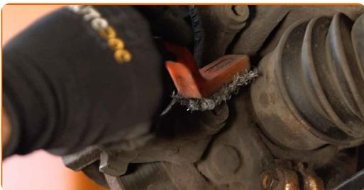
**13** Lösen Sie die Befestigung der Sattelhalterung. Verwenden Sie den Torx T55. Verwenden Sie ein Windeisen.
