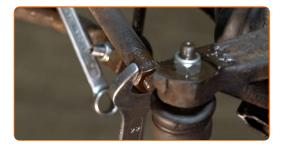
Lösen Sie das Ende der Befestigungsmutter an dem Achsschenkel. Verwenden Sie Stecknuss Nr. 17. Verwenden Sie einen Ratschenschlüssel.
