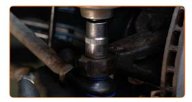
Bringen Sie den Spurstangenkopf in die richtige Position und fixieren Sie ihn mit einer Gegenmutter. Verwenden Sie einen Messschieber. Verwenden Sie Ring-Gabelschlüssel Nr. 16. Verwenden Sie Ring-Gabelschlüssel Nr. 22.
