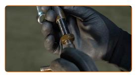
Reinigen Sie die Montagesitze des Spurstangenkopfes. Benutzen Sie eine Drahtbürste. Verwenden Sie Allzweckreinigungsspray.
