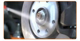
Die Bremsscheibenoberfläche reinigen. Benutzen Sie einen Bremsenreiniger.
