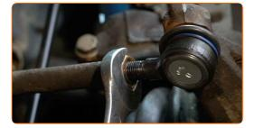
Ziehen Sie die Spurstangenkopf Sicherungsmutter an. Verwenden Sie Ring-Gabelschlüssel Nr. 16. Verwenden Sie Ring-Gabelschlüssel Nr. 22. Verwenden Sie einen Drehmomentschlüssel. Ziehen Sie ihn mit 45 Nm Drehmoment fest.
