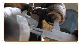
Lösen Sie die Kontermutter des Spurstangenkopf und der Zugstange. Verwenden Sie Ring-Gabelschlüssel Nr. 16. Verwenden Sie Ring-Gabelschlüssel Nr. 22.
