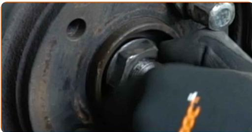
**21** Lösen Sie die Antriebswelle in der Radnabe. Verwenden Sie einen Splintentreiber. Benutzen Sie einen Hammer.
