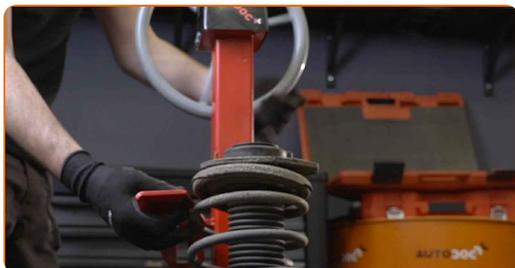
**40** Reinigen Sie die Kolbenstange des Federbeins. Benutzen Sie eine Drahtbürste. Benutzen Sie WD-40-Spray.
