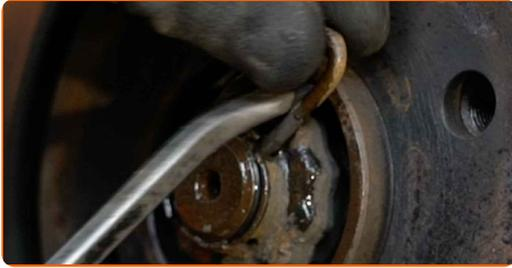
**18** Entfernen Sie den Sicherungsring.
