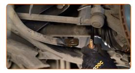
Ziehen Sie das Befestigungselement an, das die Druckstange mit dem Federbein verbindet. Verwenden Sie Stecknuss Nr. 17. Verwenden Sie einen Drehmomentschlüssel. Ziehen Sie ihn mit 40 Nm Drehmoment fest.
