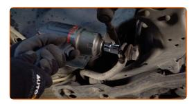
Schrauben Sie das Befestigungselement heraus, das die Druckstange mit dem Federbein verbindet. Verwenden Sie Stecknuss Nr. 17.
