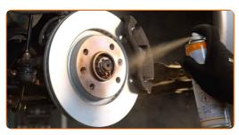
Die Bremsscheibenoberfläche reinigen. Benutzen Sie einen Bremsenreiniger.
