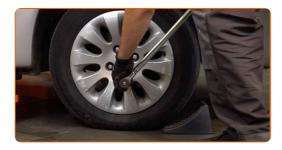
Entfernen Sie den Wagenheber sowie die Unterlegkeile.
