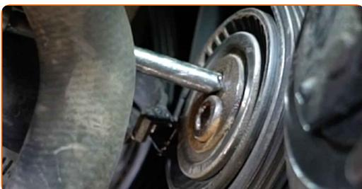
14 Entfernen Sie den Keilrippenriemen.
