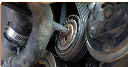
13 Ziehen Sie die Spannrolle des Keilrippenriemens beiseite. Verwenden Sie eine 1/4-Zoll-Vierkantantriebs-Verlängerungsstange. Verwenden Sie einen Ratschenschlüssel.
