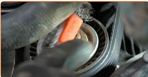
12 Lösen Sie die Befestigungen der Spannrolle. Verwenden Sie Inbusschlüssel Nr. H8. Verwenden Sie einen Ratschenschlüssel.
