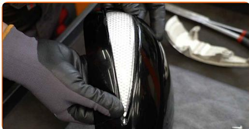
**14** Schrauben Sie die Befestigungselemente ein, die die Zusatzblinker mit dem Spiegelgehäuse verbinden. Verwenden Sie den Torx T20.
