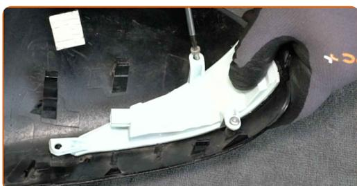
**15** Behandeln Sie den Steckverbinder des Seitenblinkers. Verwenden Sie dielektrisches Fett.
