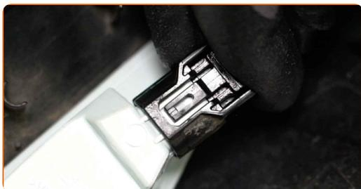
**17** Bauen Sie das Gehäuse des Außenspiegels ein. Stellen Sie sicher, dass Sie dabei das Klicken hören, welches entsteht, wenn sich diese in der korrekten Position befindet.
