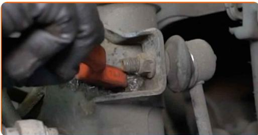
**7** Schrauben Sie das Befestigungselement heraus, das die Druckstange mit dem Federbein verbindet. Verwenden Sie Stecknuss Nr. 14. Verwenden Sie einen Ratschenschlüssel.
