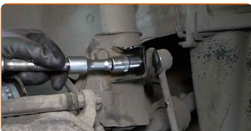
**8** Schrauben Sie das Befestigungselement heraus, das die Druckstange mit dem Stabilisator verbindet. Verwenden Sie Stecknuss Nr. 14. Verwenden Sie einen Ratschenschlüssel.
