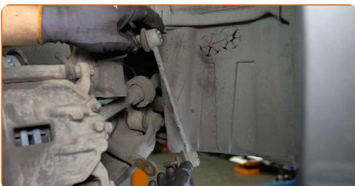
**10** Reinigen Sie die Montagesitze der Koppelstange. Benutzen Sie eine Drahtbürste.
