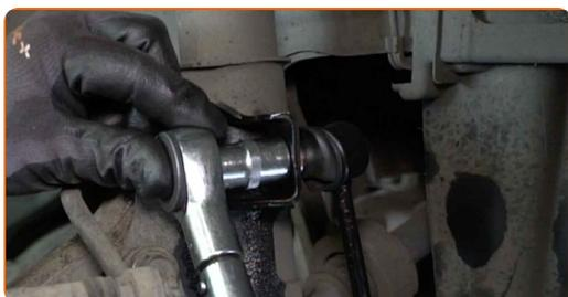
**13** Ziehen Sie das Befestigungselement an, das die Druckstange mit dem Stabilisator verbindet. Verwenden Sie Stecknuss Nr. 17. Verwenden Sie einen Drehmomentschlüssel. Ziehen Sie ihn mit 35 Nm Drehmoment fest.
