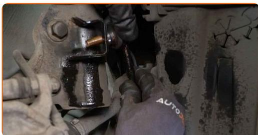
**12** Ziehen Sie das Befestigungselement an, das die Druckstange mit dem Federbein verbindet. Verwenden Sie Stecknuss Nr. 17. Verwenden Sie einen Drehmomentschlüssel. Ziehen Sie ihn mit 35 Nm Drehmoment fest.
