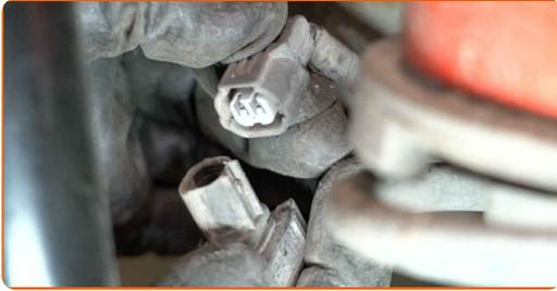
**9** Reinigen Sie die Befestigung des ABS-Sensors. Benutzen Sie eine Drahtbürste. Benutzen Sie WD-40-Spray.
