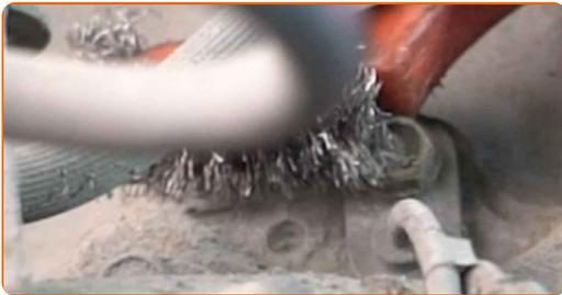
**10** Schrauben Sie die Befestigung des ABS-Sensors ab. Verwenden Sie Stecknuss Nr. 10. Verwenden Sie einen Ratschenschlüssel.
