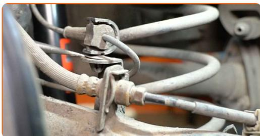
**7** Reinigen Sie den Stecker des ABS-Sensors. Verwenden Sie eine Nylon-Reinigungsbürste.
