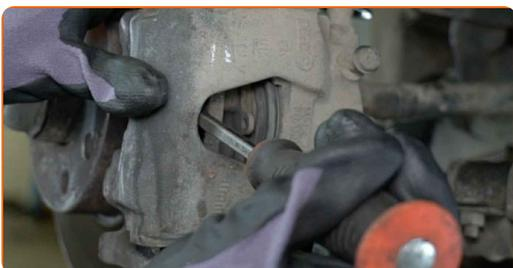
**9** Entfernen Sie die Staubschutzkappen der Bremssattel-Führungsstifte. Benutzen Sie ein Brecheisen.
