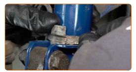
Schrauben Sie den Kabelhalter des ABS-Sensors fest. Verwenden Sie Stecknuss Nr. 6. Verwenden Sie einen Ratschenschlüssel.
