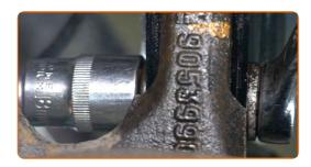
Entfernen Sie die Befestigungsschrauben.
