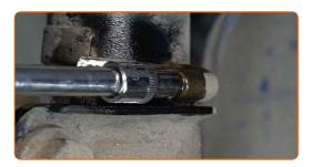
11 Trennen Sie die Verkabelung des ABS-Sensors.
