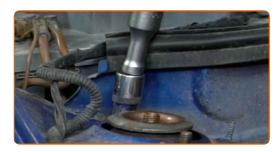
Behandeln Sie die Befestigungselemente des Federbeinstützlagers. Benutzen Sie ein Kupferschmiermittel.
