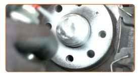
Die Bremsscheibenoberfläche reinigen. Benutzen Sie einen Bremsenreiniger.
