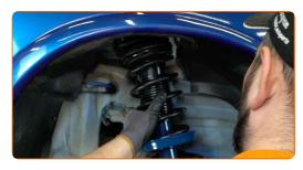
Sichern Sie die oberen Befestigungen des Federbeines. Schrauben Sie diese nicht fest.
