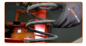
Entnehmen Sie den alten Stoßdämpfer aus dem hydraulischen Spiralfederspanner.
