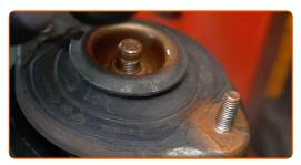
35 Dekomprimieren Sie die Feder.
