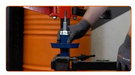
Installieren Sie die Feder am Stoßdämpfer.
