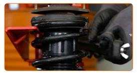
Entfernen Sie das zusammengebaute Federbein.
