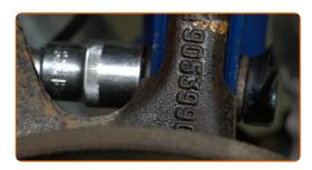
Ziehen Sie die unteren Befestigungen an, die das Federbein mit dem Achsschenkel verbinden. Verwenden Sie Ring-Gabelschlüssel Nr. 18. Verwenden Sie Stecknuss Nr. 18. Verwenden Sie einen Drehmomentschlüssel. Ziehen Sie ihn mit 90 Nm Drehmoment fest.+45°+15°
