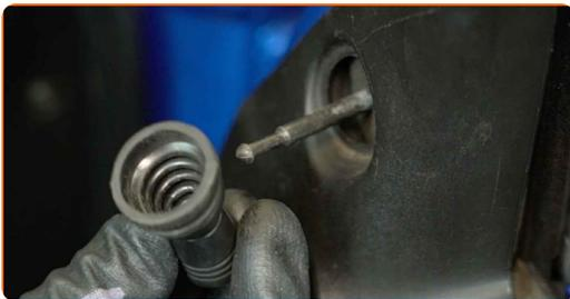
**4** Lösen Sie die Dreiecksblende des Außenspiegels. Verwenden Sie einen Zierleistenkeil.
