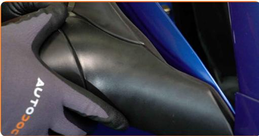
9 Ziehen Sie die Schrauben des Außenspiegels fest. Verwenden Sie Stecknuss Nr. 8. Verwenden Sie einen Drehmomentschlüssel. Ziehen Sie ihn mit 8 Nm Drehmoment fest.
