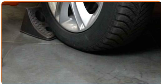
5 Lösen Sie die Radhalterungsschrauben. Verwenden Sie eine Schlagnuss für Felgen # 17.
