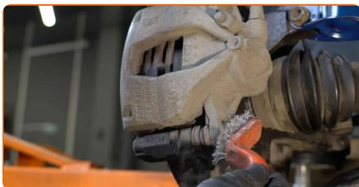
**10** Schrauben Sie die Befestigung des Bremssattels ab. Verwenden Sie Stecknuss Nr. 13. Verwenden Sie einen Ratschenschlüssel.
