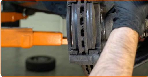
**Austausch: Bremsscheiben – Opel Corsa D. Fachleute empfehlen:**
