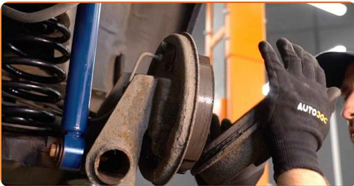
**10** Reinigen Sie den Einbauort für die Nabenlagerung. Verwenden Sie Allzweckreinigungsspray.
