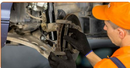
**36** Installieren Sie den Bremssattel und fixieren Sie diesen. Verwenden Sie Inbusschlüssel Nr. H7. Verwenden Sie einen Drehmomentschlüssel. Ziehen Sie ihn mit 30 Nm Drehmoment fest.
