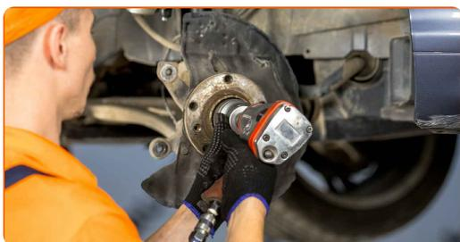
**23** Entfernen Sie die Nabe und das Lager zusammen, da sie eine versiegelte Einheit sind.
