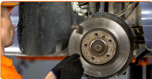
**34** Befestigen Sie die Bremssattelhalterung. Verwenden Sie Stecknuss Nr. 16. Verwenden Sie einen Drehmomentschlüssel. Ziehen Sie ihn mit 110 Nm Drehmoment fest.
