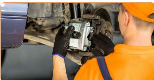
**37** Installieren Sie die Staubschutzkappen der Bremssattel-Führungsstifte.
