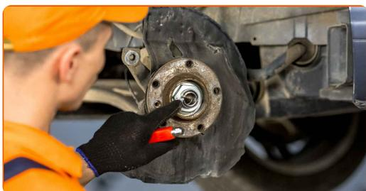
**22** Schrauben Sie die Nabenlagerhalterung ab. Verwenden Sie Stecknuss Nr. 46. Verwenden Sie ein Windeisen.
