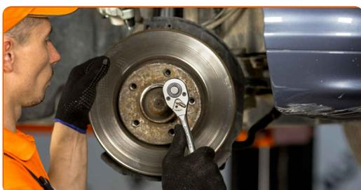
**32** Säubern Sie die Halterung des Bremsstellers. Benutzen Sie eine Drahtbürste. Benutzen Sie einen Bremsenreiniger.
