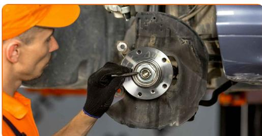
**28** Installieren Sie die Schutzkappe des Nabenlagers. Benutzen Sie einen Hammer.
