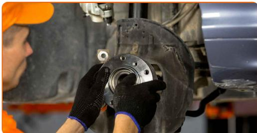
**26** Ziehen Sie das Befestigungselement des Radnabenlagers an. Verwenden Sie Stecknuss Nr. 46. Verwenden Sie einen Drehmomentschlüssel. Ziehen Sie ihn mit 290 Nm Drehmoment fest.
