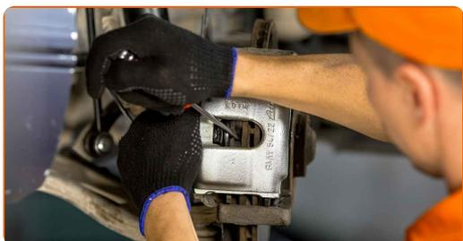
**11** Entfernen Sie den Bremssattel.
