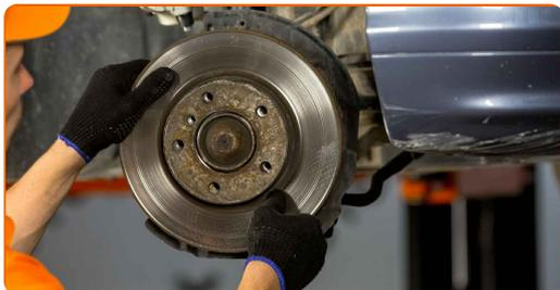
**31** Ziehen Sie die Befestigung der Bremsscheibe fest. Verwenden Sie Inbusschlüssel Nr. H6. Verwenden Sie einen Drehmomentschlüssel. Ziehen Sie ihn mit 9 Nm Drehmoment fest.
