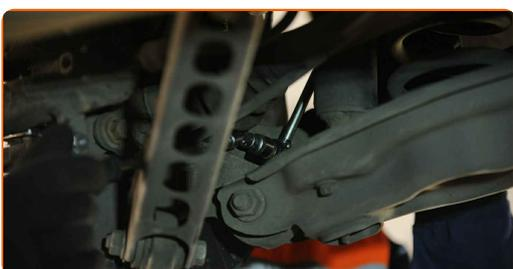
**14** Ziehen Sie das Befestigungselement an, das die Druckstange mit dem Stabilisator verbindet. Verwenden Sie Ring-Gabelschlüssel Nr. 17 (2 Stück). Verwenden Sie einen Drehmomentschlüssel. Ziehen Sie ihn mit 58 Nm Drehmoment fest.
