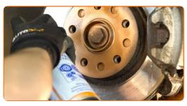
Die Bremsscheibenoberfläche reinigen. Benutzen Sie einen Bremsenreiniger.
