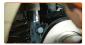
Entfernen Sie den Träger unter der Achsschenkelachse.
