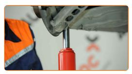
Ziehen Sie den Lenker am Achsschenkel an. Verwenden Sie Stecknuss Nr. 18. Verwenden Sie ein Windeisen. Verwenden Sie einen Drehmomentschlüssel. Ziehen Sie ihn mit 100 Nm Drehmoment fest.
