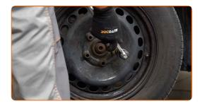
Entfernen Sie den Wagenheber sowie die Unterlegkeile.
