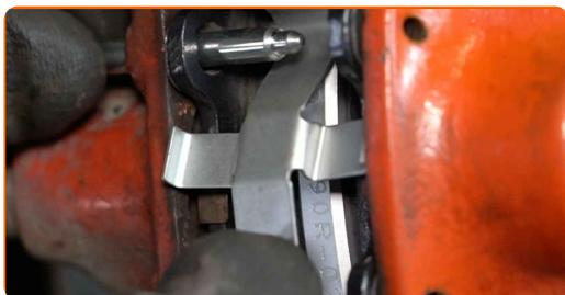
**45** Montieren Sie die Führungsbolzen der Bremsbeläge. Verwenden Sie einen Splintentreiber. Benutzen Sie einen Hammer.
