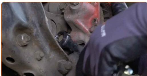
**15** Entfernen Sie die Befestigungsschrauben.
