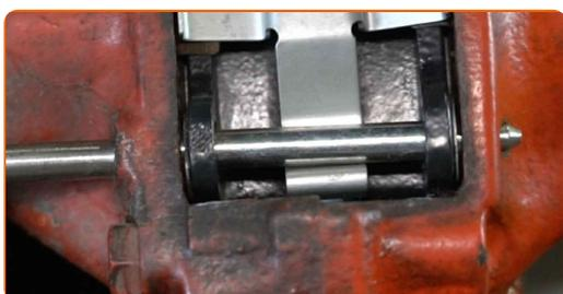
**46** Die Bremsscheibenoberfläche reinigen. Benutzen Sie einen Bremsenreiniger.
