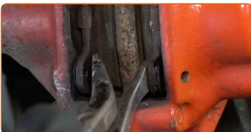
**12** Entfernen Sie die Bremsbeläge.
