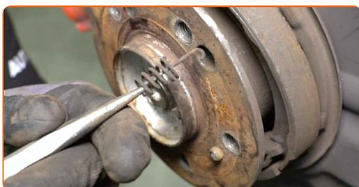
**24** Entfernen Sie die Bremsbacken der Feststellbremse.
