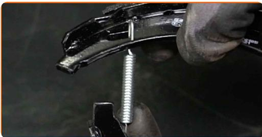
**30** Montieren Sie den Nachsteller der Feststellbremse.
