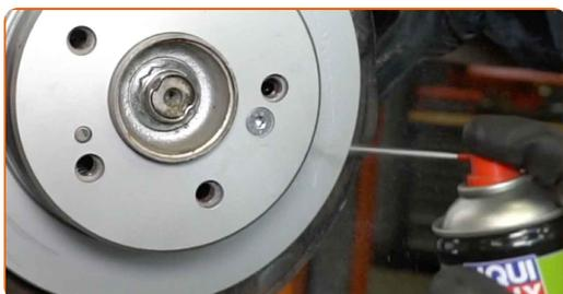
**47** Behandeln Sie die Oberfläche, an der die Bremsscheibe die Felge berührt. Verwenden Sie Keramikfett.
