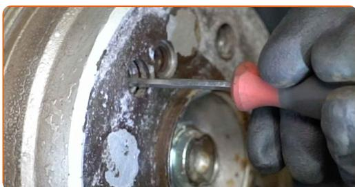
**21** Entfernen Sie die Bremsscheibe.
