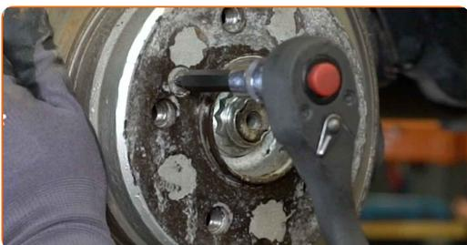
**19** Entfernen Sie die Befestigungsschraube.
