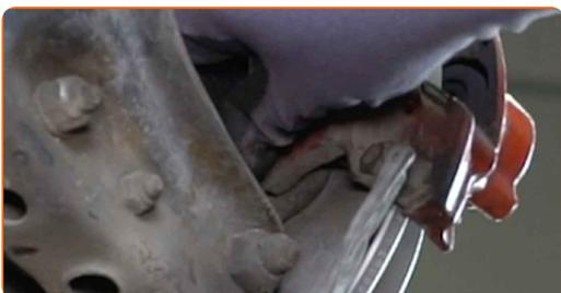
**42** Ziehen Sie die Bremssattelbefestigungen fest. Verwenden Sie Stecknuss Nr. 17. Verwenden Sie einen Drehmomentschlüssel. Ziehen Sie ihn mit 65 Nm Drehmoment fest.
