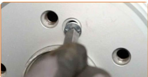
**38** Schrauben Sie die Befestigungen der Bremsscheibe fest. Verwenden Sie Inbusschlüssel Nr. H5. Verwenden Sie einen Drehmomentschlüssel. Ziehen Sie ihn mit 10 Nm Drehmoment fest.
