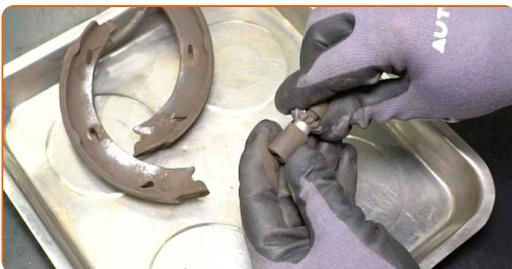
**27** Reinigen Sie den Nachsteller der Feststellbremse. Benutzen Sie eine Drahtbürste. Verwenden Sie Allzweckreinigungsspray.
