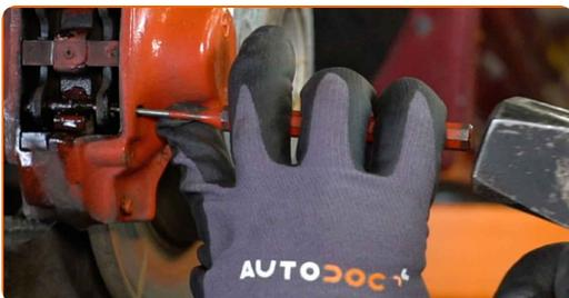
**10** Entfernen Sie die Rückholfeder der Bremsbeläge.
