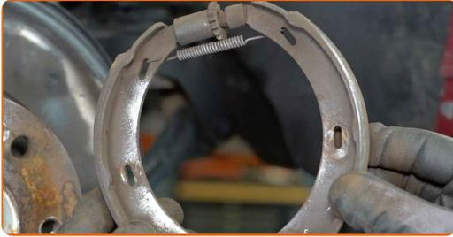
**25** Reinigen Sie die Montagesitze der Feststellbremsbacken. Benutzen Sie eine Drahtbürste. Verwenden Sie Allzweckreinigungsspray.
