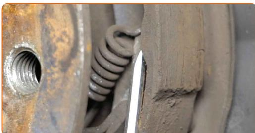
**23** Entfernen Sie die Niederhaltefedern der Feststellbremssbacken. Verwenden Sie eine Spitzzange.
