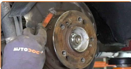
**26** Entfernen Sie den Nachsteller der Feststellbremse.
