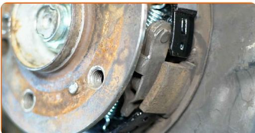
**34** Reinigen Sie die Radnabe. Benutzen Sie eine Drahtbürste.
