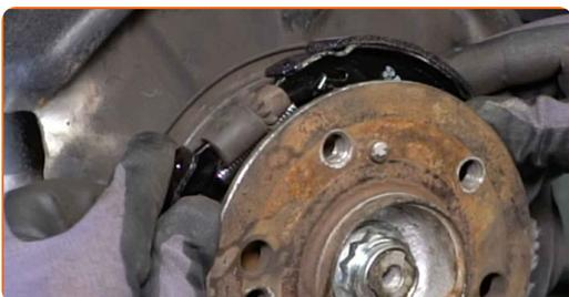
**32** Montieren Sie die Niederhaltefedern der Feststellbremsbacken. Verwenden Sie eine Spitzzange.
