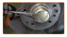
18 Entfernen Sie die Kontaktfeder.
