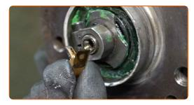
Lockern Sie die Schraube der Radnabenmutter. Verwenden Sie Inbusschlüssel Nr. H5. Verwenden Sie einen Ratschenschlüssel.
