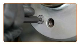
Schrauben Sie die Befestigungen der Bremsscheibe fest. Verwenden Sie Inbusschlüssel Nr. H5. Verwenden Sie einen Drehmomentschlüssel. Ziehen Sie ihn mit 10 Nm Drehmoment fest.
