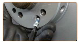
16 Entfernen Sie die Bremsscheibe.
