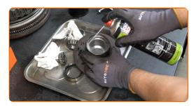
Montieren Sie die Außenringe der neuen Radlager. Verwenden Sie einen Druckstücksatz mit Ein-/Auspresswerkzeug.
