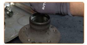
Demontieren Sie die Lageraußenringe. Verwenden Sie einen Druckstücksatz mit Ein-/Auspresswerkzeug. Verwenden Sie einen Universalabzieher.
