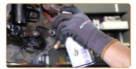
Schrauben Sie die Befestigungen des Bremssattelhalters ab. Verwenden Sie Ring-Gabelschlüssel Nr. 19.
