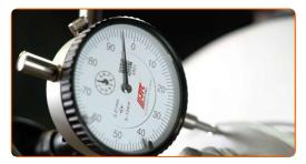
Passen Sie das Axialspiel an, indem Sie die Einstellmutter anziehen. Verwenden Sie Ring-Gabelschlüssel Nr. 22.
