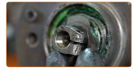
Entfernen Sie die Radnabe zusammen mit dem Lager.
