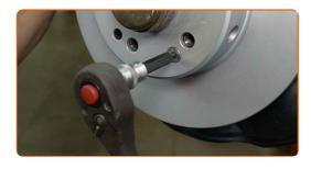
Entfernen Sie die Befestigungsschraube.
