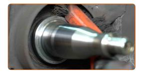
Entfernen Sie die Lagerteile aus der Radnabe. Verwenden Sie einen Druckstücksatz mit Ein-/Auspresswerkzeug.
