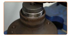
Schmieren Sie die Radlager mit Radlagerfett ein. Verwenden Sie Lagerfett.
