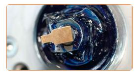
Bauen Sie die Schutzkappe des Nabenlagers ein. Verwenden Sie einen Druckstücksatz mit Ein-/Auspresswerkzeug.
