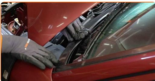
**37** Setzen Sie das mittlere Element ein, das die Dichtung der Wasserkastenabdeckung hält.
