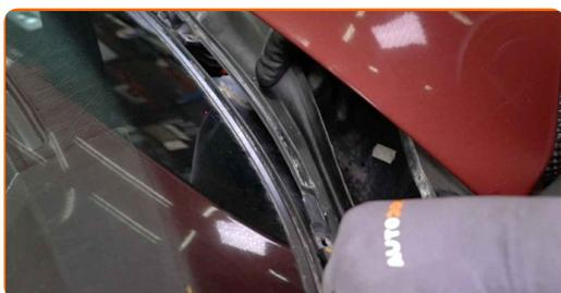
**35** Schrauben Sie die Befestigungsschrauben des Ablaufs ein. Verwenden Sie einen Kreuzschlitzschraubendreher.
