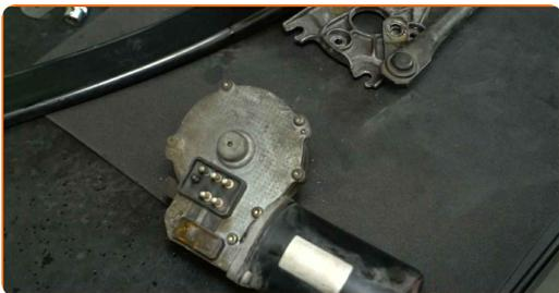
**21** Reinigen Sie den Montagesitz des Wischermotors. Benutzen Sie eine Drahtbürste. Verwenden Sie Allzweckreinigungsspray.
