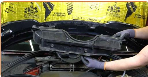
**9** Decken Sie den Innenraumfilter mit einem Mikrofasertuch ab, um das Eindringen von Schmutz und Fremdkörpern zu verhindern.
