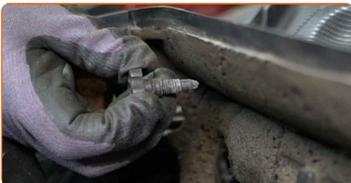
**5** Entfernen Sie das Gummiformteil der Windschutzscheibe.
