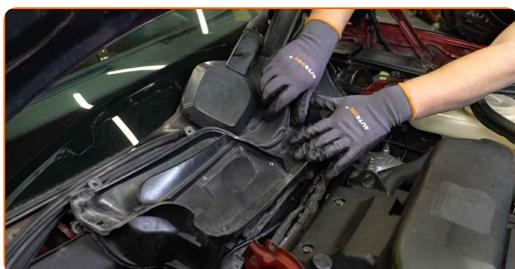
**34** Montieren Sie die seitlichen Wasserabläufe.
