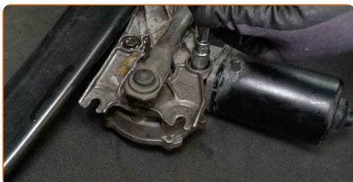
**18** Entfernen Sie die Befestigungsschrauben.
