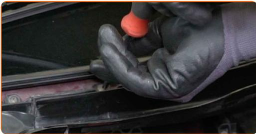
**7** Demontieren Sie die seitlichen Wasserabläufe.
