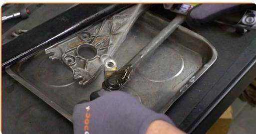
**22** Montieren Sie einen neuen Wischermotor.
