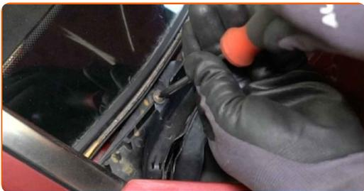
**36** Setzen Sie das Gummiformteil der Windschutzscheibe ein.
