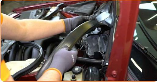
**6** Schrauben Sie die Befestigungsschrauben des Ablaufs ab. Verwenden Sie einen Kreuzschlitzschraubendreher.
