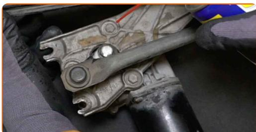
**16** Lösen Sie die Befestigungsmutter, die das Gestänge mit der Welle des Wischermotors verbindet. Verwenden Sie Stecknuss Nr. 13. Verwenden Sie einen Ratschenschlüssel.
