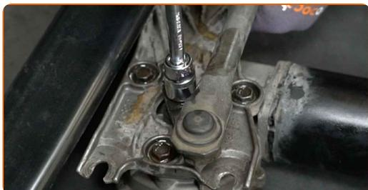
**17** Schrauben Sie die Befestigungsschrauben des Wischermotors ab. Verwenden Sie Stecknuss Nr. 10. Verwenden Sie einen Ratschenschlüssel.
