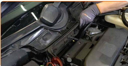
**38** Bringen Sie die Dichtung der Wasserkastenabdeckung an.
