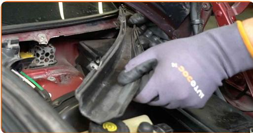
**8** Entfernen Sie den mittleren Teil des Ablaufs.
