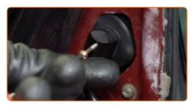
Schrauben Sie die Befestigungsschraube vom Steckverbinder des Außenspiegels ein. Verwenden Sie einen Kreuzschlitzschraubendreher.
