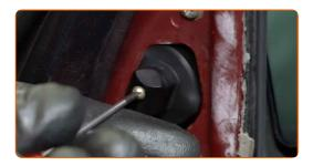
Montieren Sie die Abdeckung des Außenspiegels.
