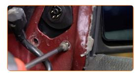
Behandeln Sie den Steckverbinder des Außenspiegels mit einem Kontaktspray. Verwenden Sie dielektrisches Fett.
