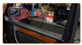
Entfernen Sie die Abdeckung, die die Befestigungsschrauben der Außenspiegel verdeckt. Verwenden Sie einen Zierleistenkeil.
