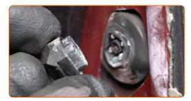
Schrauben Sie die Befestigungsschrauben der Außenspiegel ab. Verwenden Sie einen Kreuzschlitzschraubendreher.
