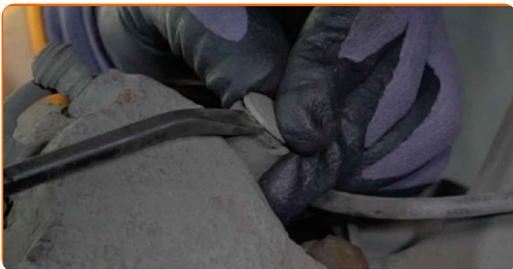
**12** Schrauben Sie die Befestigungen des Bremssattels ab. Verwenden Sie Inbusschlüssel Nr. H7. Verwenden Sie einen Ratschenschlüssel.
