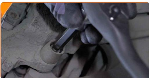
**13** Entfernen Sie den Bremssattel.
