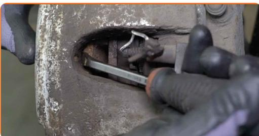
**11** Entfernen Sie die Kappen der Führungsbolzenmanschetten des Bremssattels. Benutzen Sie ein Brecheisen.
