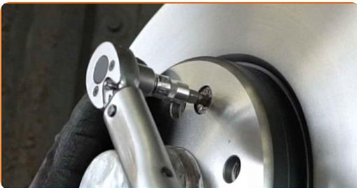
**28** Entfernen Sie Schmutz und Staub vom Bremssattelhalter. Benutzen Sie eine Drahtbürste. Benutzen Sie einen Bremsenreiniger.
