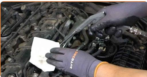
**12** Schrauben Sie die Glühkerzen aus. Verwenden Sie die Zündkerzennuss # 10. Verwenden Sie einen Drehmomentschlüssel.
