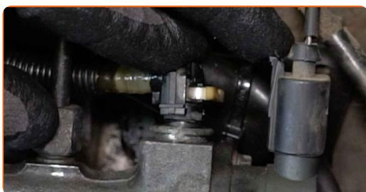
**22** Ziehen Sie die Befestigungsschraube des Kraftstoffschlauchs fest. Verwenden Sie Stecknuss Nr. E11. Verwenden Sie einen Drehmomentschlüssel. Ziehen Sie ihn mit 8 Nm Drehmoment fest.
