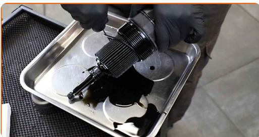
**21** Lösen Sie den Ölfilter vom Filterdeckel. Verwenden Sie einen flachen Schraubendreher.
