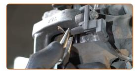
Lösen Sie die Bremssattel-Haltefeder. Benutzen Sie ein Brecheisen.
