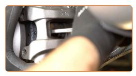
Entfernen Sie den Bremssattel.
