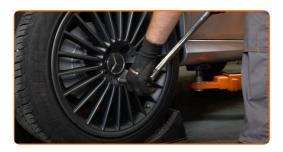
Entfernen Sie den Wagenheber sowie die Unterlegkeile.
