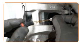
Bringen Sie den Steckverbinder des Verschleißsensors der Bremsbeläge an.
