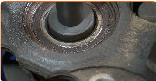
**41** Setzen Sie den Achsschenkel in den Schraubstock.
