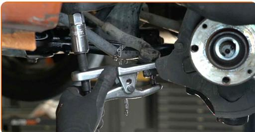
**27** Reinigen Sie den Befestigungssitz des ABS-Sensors. Benutzen Sie eine Drahtbürste. Benutzen Sie WD-40-Spray.
