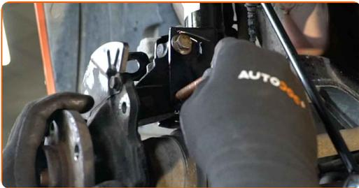
**57** Schrauben Sie die Befestigungen ein, die das Federbein mit dem Achsschenkel verbinden. Verwenden Sie Ring-Gabelschlüssel Nr. 15. Verwenden Sie Stecknuss Nr. 17. Verwenden Sie einen Ratschenschlüssel.
