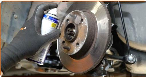
**22** Lösen Sie die Befestigung der Bremsscheibe. Verwenden Sie Stecknuss Nr. 12. Verwenden Sie einen Ratschenschlüssel.
