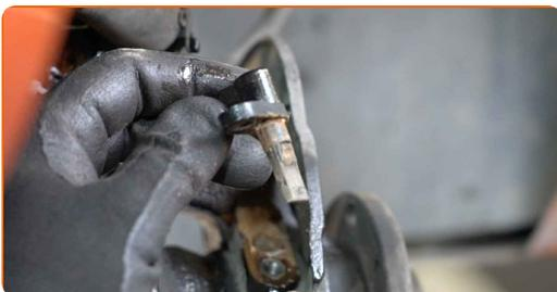
**30** Lösen Sie die Verdrahtung und den Bremsschlauch aus der Halterung am Federbein. Benutzen Sie ein Brecheisen.
