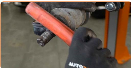
**52** Reinigen Sie das Befestigungselement, das den Spurstangenkopf mit dem Achsschenkel verbindet. Benutzen Sie eine Drahtbürste. Benutzen Sie WD-40-Spray.
