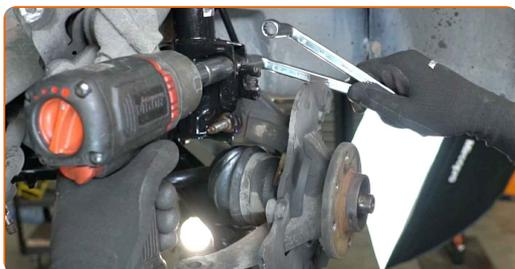
**35** Entfernen Sie die Befestigungsschrauben.
