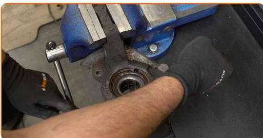
**42** Entfernen Sie den Sicherungsring am Radnabenlager. Verwenden Sie Schraubenzieher (2 Teile).
