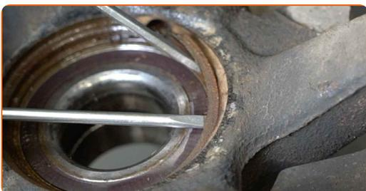
**43** Reinigen Sie den Einbauort für die Nabenlager. Benutzen Sie eine Drahtbürste. Benutzen Sie WD-40-Spray.
