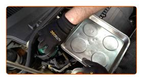
Schrauben Sie den Filtergehäusedeckel zusammen mit dem alten Filterelement ab. Legen Sie die alte Filterpatrone in den Behälter.
