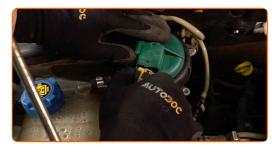
Schrauben Sie die Kraftstofffilterabdeckung ab.
