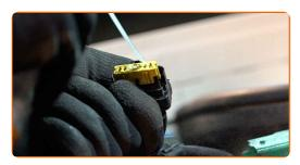
Bringen Sie den Anschluss des Kraftstoffdrucksensors an.
