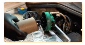
9 Befestigen Sie den Kraftstofffilter am Halter.
