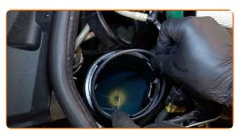
Installieren Sie einen neuen Kraftstofffilter.
