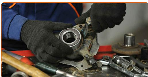
**28** Installieren Sie den Haltering in dem Achsschenkel. Verwenden Sie einen flachen Schraubendreher.
