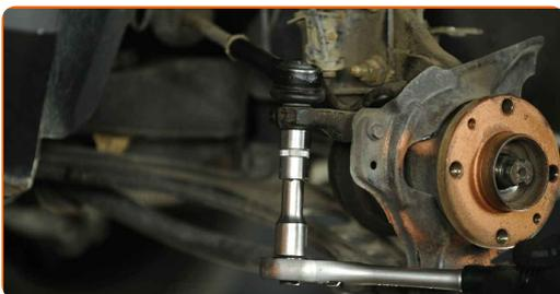
**14** Ziehen Sie den Spurstangenkopf vom Achsschenkel. Verwenden Sie einen Kugelgelenkabzieher.
