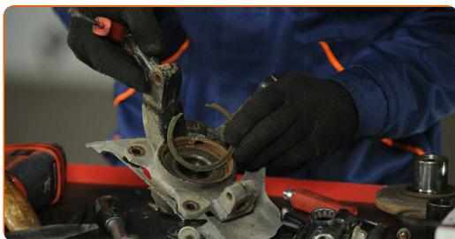
**26** Drücken Sie das Radnabenlager heraus.
