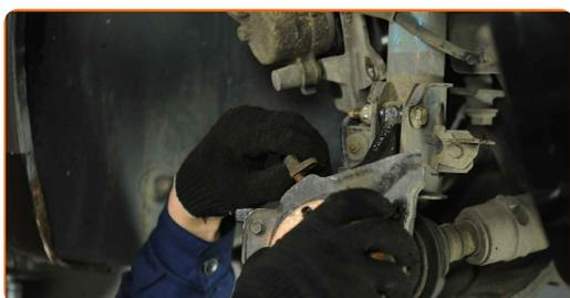
**35** Schrauben Sie die Nabenmutter an. Verwenden Sie Stecknuss Nr. 36. Verwenden Sie ein Windeisen.
