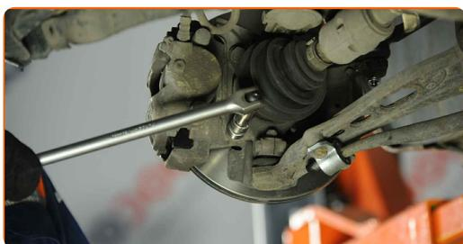
**6.2** Verwenden Sie Stecknuss Nr. 17. Verwenden Sie einen Ratschenschlüssel. Verwenden Sie ein Windeisen.
