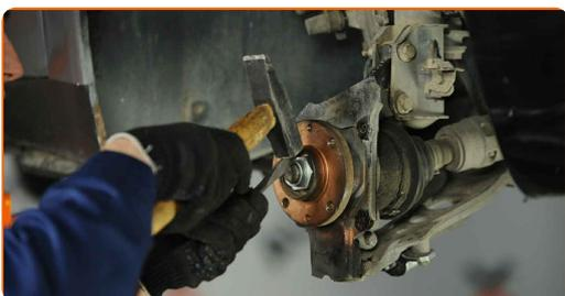
**37** Bringen Sie die Bremsscheibe an und sichern Sie diese. Verwenden Sie Stecknuss Nr. 12.
