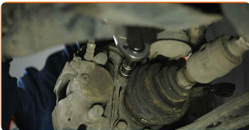
**39.3** Verwenden Sie einen Drehmomentschlüssel. Halten Sie das empfohlene Anzugsdrehmoment ein.
