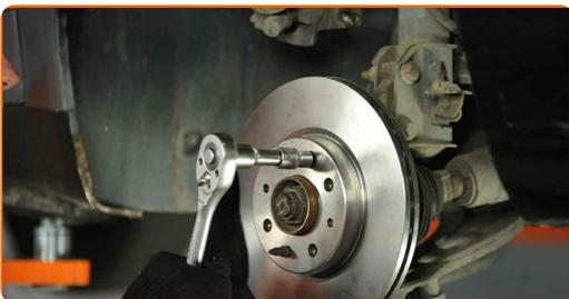
**10** Entfernen Sie die Bremsscheibe.
