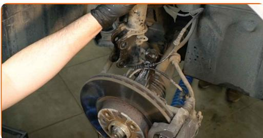
**22** Lösen Sie die obere Befestigung des Domlagers.
