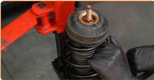
**42** Installieren Sie das Federbein am Radlauf.
