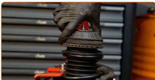
**38** Ziehen Sie die Federbeinkolbenstangenmutter an. Verwenden Sie Inbusschlüssel Nr. H8. Verwenden Sie Stecknuss Nr. 17. Verwenden Sie einen Drehmomentschlüssel. Ziehen Sie ihn mit 44 Nm Drehmoment fest.
