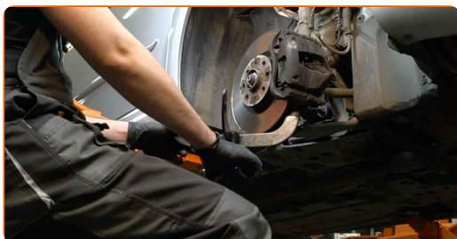
**20** Entfernen Sie die Befestigungsschrauben.
