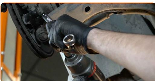
**8** Entfernen Sie die Befestigungsschraube.
