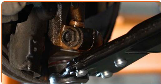
**22** Schrauben Sie die Befestigungen des Kugelgelenks ein. Verwenden Sie Ring-Gabelschlüssel Nr. 16. Verwenden Sie Stecknuss Nr. 16. Verwenden Sie einen Ratschenschlüssel.
