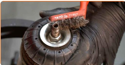
**27** Entfernen Sie die Stangenmutter des Federkolben. Verwenden Sie Inbusschlüssel Nr. H6. Verwenden Sie Stecknuss Nr. 18. Verwenden Sie einen Ratschenschlüssel.
