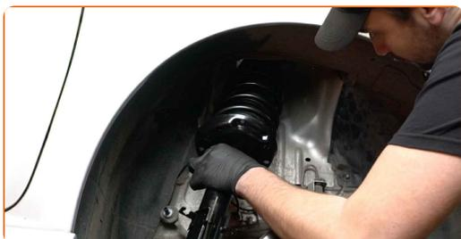
**41** Schrauben Sie die obere Befestigung des Domlagers an. Schrauben Sie diese nicht fest.
