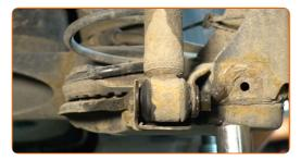
Den Stoßdämpfer entfernen.
