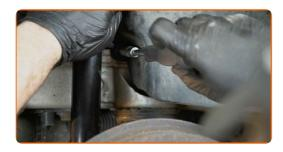
Ziehen Sie den unteren Befestiger des Stoßdämpfers an. Verwenden Sie Stecknuss Nr. E18. Verwenden Sie einen Drehmomentschlüssel. Ziehen Sie ihn mit 120 Nm Drehmoment fest.
