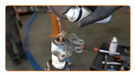
Platzieren Sie den Stoßdämpfer auf dem Radlauf und sichern Sie ihn.
