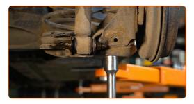
Schrauben Sie den unteren Befestiger des Stoßdämpfers ab. Verwenden Sie Stecknuss Nr. E18. Verwenden Sie einen Ratschenschlüssel.
