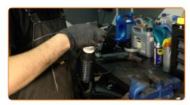
Ziehen Sie die Mutter der Stoßdämpferkolbenstange fest. Verwenden Sie einen Stoßdämpfer Steckschlüsseleinsatz DDNº6. Verwenden Sie Stecknuss Nr. 16. Verwenden Sie einen Drehmomentschlüssel. Ziehen Sie ihn mit 35 Nm Drehmoment fest.
