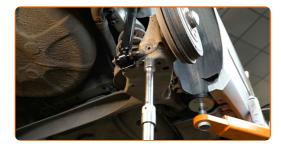
Ziehen Sie die obere Stoßdämpferbefestigung an. Verwenden Sie Stecknuss Nr. E16. Verwenden Sie einen Drehmomentschlüssel. Ziehen Sie ihn mit 72 Nm Drehmoment fest.
