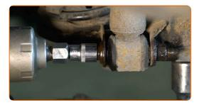
Schrauben Sie das obere Befestigungselement des Stoßdämpfers ab. Verwenden Sie Stecknuss Nr. E16. Verwenden Sie einen Ratschenschlüssel.
