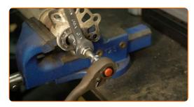
Entfernen Sie die Stoßdämpferhalterung, die Manschette und den Stoßstopp.
