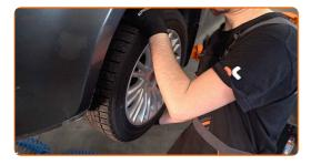
Schrauben Sie die Befestigungselemente der Radkastenabdeckung heraus und entfernen Sie sie. Verwenden Sie einen Kreuzschlitzschraubendreher. Verwenden Sie Stecknuss Nr. 10. Verwenden Sie einen Ratschenschlüssel.
