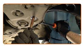
Stützen Sie den Arm. Benutzen Sie einen hydraulischen Getriebeheber.
