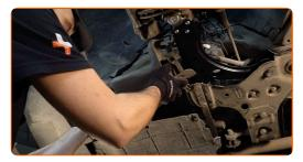
Bringen Sie die Befestigungselemente der Radkastenabdeckung an und ziehen Sie diese an. Verwenden Sie einen Kreuzschlitzschraubendreher. Verwenden Sie Stecknuss Nr. 10. Verwenden Sie einen Ratschenschlüssel.
