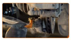
Schrauben Sie die Kugelgelenkbefestigung vom Achsschenkel ab. Verwenden Sie Ring-Gabelschlüssel Nr. 17. Verwenden Sie einen Ratschenschlüssel.
