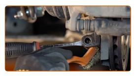
Installieren Sie den Arm. Verwenden Sie einen Splintentreiber.
