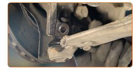
Schrauben Sie die vordere Armbefestigung ab. Verwenden Sie Stecknuss Nr. 21. Verwenden Sie ein Windeisen.
