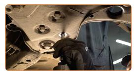
Setzen Sie das Verbindungselement, welches das Kugelegelenk mit dem Achsschenkel verbindet, frei. Benutzen Sie ein Brecheisen. Benutzen Sie einen Hammer.
