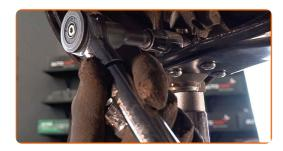
Ziehen Sie das vordere Befestigungselement an, das den Querlenker mit dem Hilfsrahmen verbindet. Verwenden Sie Stecknuss Nr. 21. Verwenden Sie einen Drehmomentschlüssel. Ziehen Sie ihn mit 95 Nm Drehmoment fest.+90°
