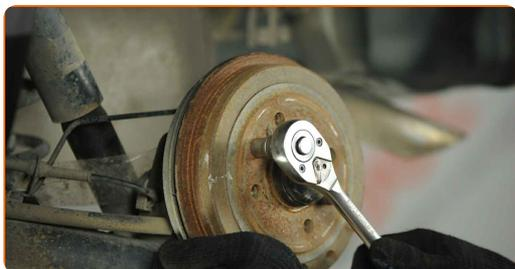
**9** Verwenden Sie Stecknuss Nr. 12. Verwenden Sie einen Ratschenschlüssel.
