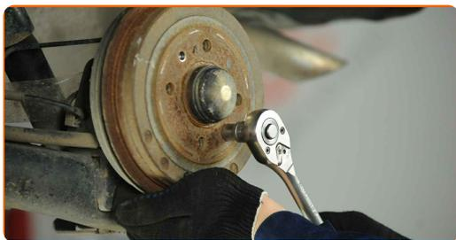
**10** Entfernen Sie die Bremstrommel.
