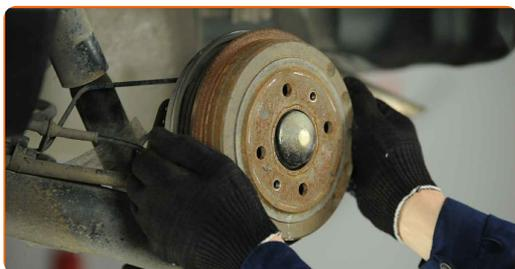
**11** Entfernen Sie die Schutzkappe des Nabenlagers. Verwenden Sie einen flachen Schraubendreher. Benutzen Sie einen Hammer.
