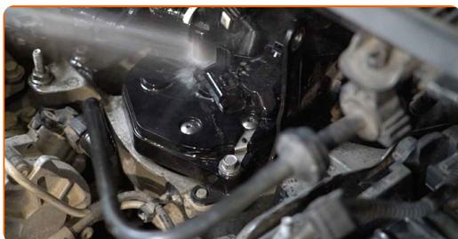
**26** Schrauben Sie die Befestigungsbolzen der Treibstofffilterhalterung an. Verwenden Sie Stecknuss Nr. 8. Verwenden Sie einen Ratschenschlüssel.
