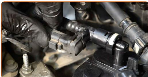
**24** Bringen Sie den Anschluss des Kraftstoffdrucksensors an.
