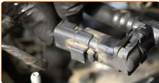
**25** Reinigen Sie die Befestigungen der Kraftstoff-Zuleitungen. Verwenden Sie Allzweckreinigungsspray.
