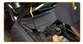
Schrauben Sie die Befestigungen der Windlaufabdeckung an, die sich auf der rechten Seite befindet. Verwenden Sie einen Kreuzschlitzschraubendreher.
