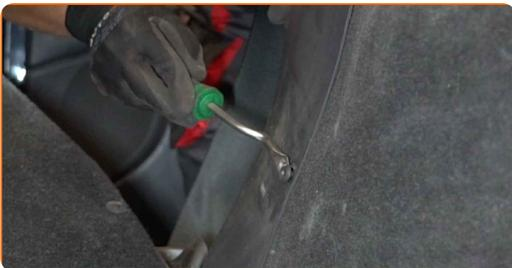
**8** Entfernen Sie die Seitenabdeckung aus Kunststoff.
