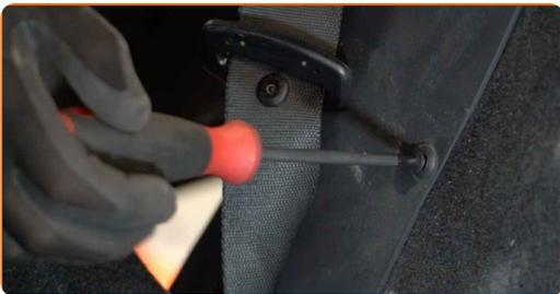
**7** Entfernen Sie die Clips der Seitenverkleidung aus Kunststoff. Verwenden Sie einen Lösehebel, um die Clips zu entfernen.
