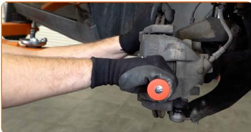
**8** Die Befestigungselemente der Bremssattelhalterung reinigen. Benutzen Sie eine Drahtbürste. Behandeln Sie die Befestigungsschrauben der Bremssattelhalterung. Benutzen Sie WD-40-Spray.
