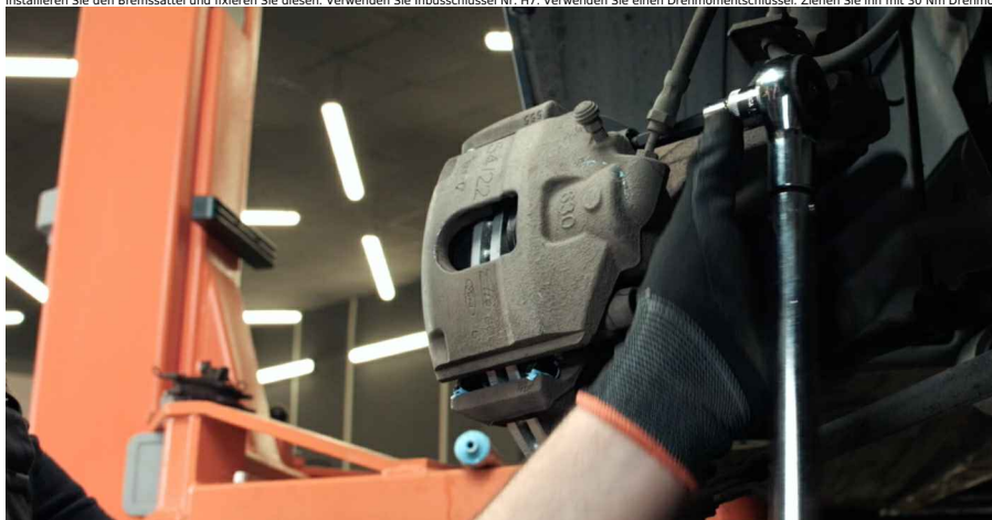
26 Installieren Sie die Staubschutzkappen der Bremssattel-Führungsstifte.
