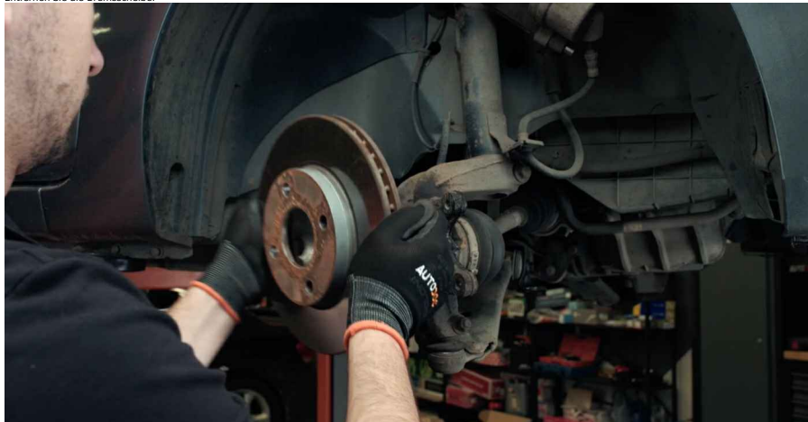
17 Säubern Sie die Halterung des Bremssattels. Benutzen Sie eine Drahtbürste. Benutzen Sie einen Bremsenreiniger.
