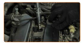
Schrauben Sie die neuen Zündkerzen an und ziehen Sie diese fest. Verwenden Sie die Zündkerzennuss # 16. Verwenden Sie einen Drehmomentschlüssel. Ziehen Sie ihn mit 20 Nm Drehmoment fest.
