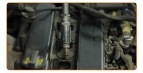
Die Zündkerzenstecker in die Zündkerzenbohrung einstecken. Stellen Sie sicher, dass Sie dabei das Klicken hören, welches entsteht, wenn sich diese in der korrekten Position befindet.
