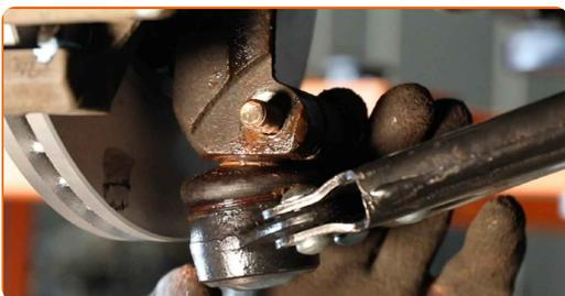
**57** Schrauben Sie die Befestigungen des Kugelgelenks ein. Verwenden Sie Stecknuss Nr. 15. Verwenden Sie den Torx T50. Verwenden Sie einen Ratschenschlüssel.
