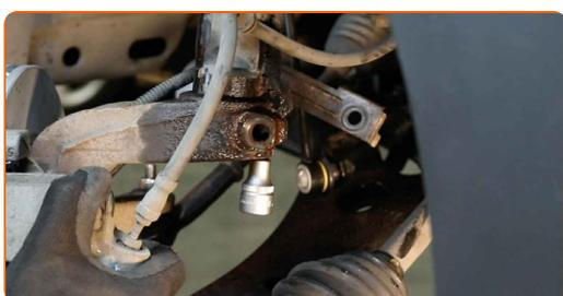
**28** Ziehen Sie den Achsschenkel vom Dämpferbein ab. Benutzen Sie einen Hammer.
