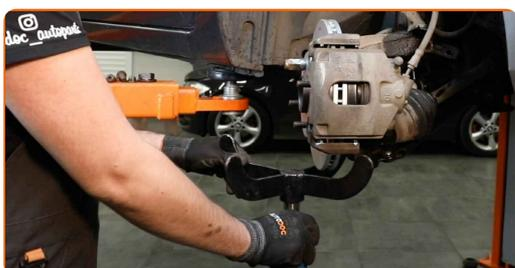
**27** Lösen Sie das untere Befestigungselement, dass das Federbein mit dem Achsschenkel verbindet. Verwenden Sie eine spezielle Schraubnuss, um den Stoßdämpfer zu entfernen.
