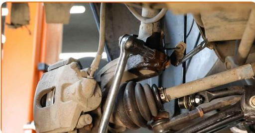
**17** Entfernen Sie die Befestigungsschraube.
