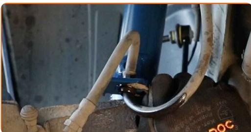
**60** Montieren Sie den Querlenker.
