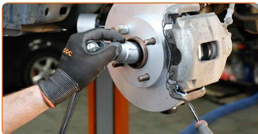
**20** Entfernen Sie die Befestigungsmutter. Verwenden Sie Stecknuss Nr. 32.
