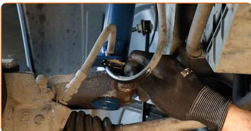
**59** Bringen Sie die Halteklammer des Bremsschlauchs an. Verwenden Sie einen Gummi-Hammer.
