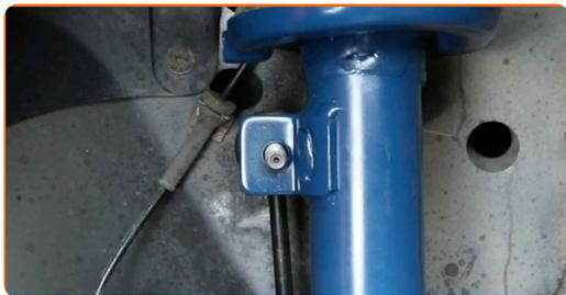
**61** Ziehen Sie die Befestigungselemente des Stabilenkers fest. Verwenden Sie Stecknuss Nr. 17. Verwenden Sie einen Ratschenschlüssel.
