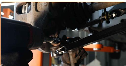
**58** Befestigen Sie den Bremsschlauch an der Strebe.
