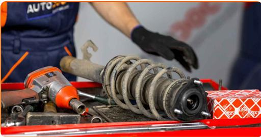
33 Schrauben Sie die obere Befestigung des Domlagers an.
