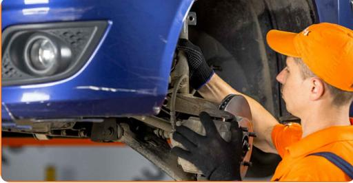
39 Befestigen Sie das Dämpferbein auf dem Achsschenkel. Benutzen Sie einen Hammer. Benutzen Sie ein Brechisen.
