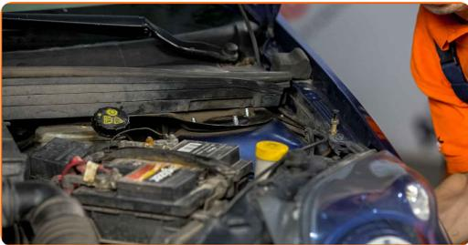
34 Ziehen Sie die obere Befestigung des Domlagers fest. Verwenden Sie Ring-Gabelschlüssel Nr. 13. Verwenden Sie einen Drehmomentschlüssel. Ziehen Sie ihn mit 30 Nm Drehmoment fest.
