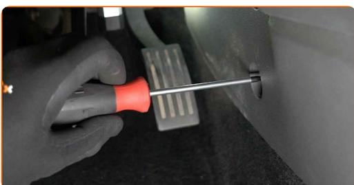
**3** Entfernen Sie die Seitenabdeckung aus Kunststoff.
