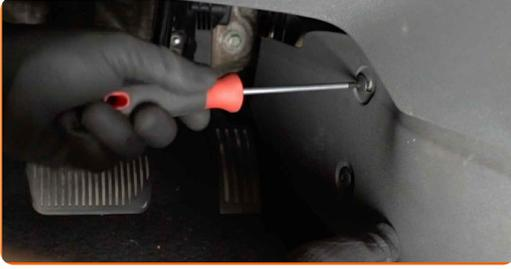
18 Setzen Sie die Kappen der Befestigungen der Kunststoffseitenverkleidung wieder auf.
