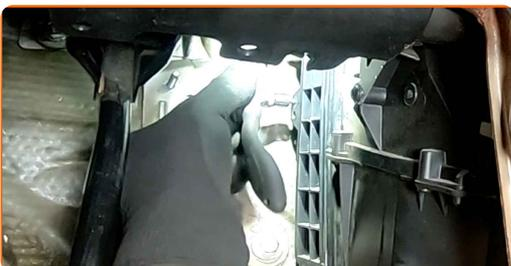
**13** Befestigen Sie den Gaspedalanschluss.
