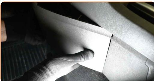
17 Schrauben Sie die Befestigungen der Kunststoffplatten der Seitenverkleidung ein. Verwenden Sie den Torx T20.
