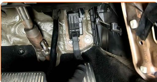
**15** Bringen Sie das Gaspedal in seine Ursprungsposition zurück und schrauben Sie sein Befestigungselement ein. Verwenden Sie Stecknuss Nr. 10. Verwenden Sie einen Ratschenschlüssel.
