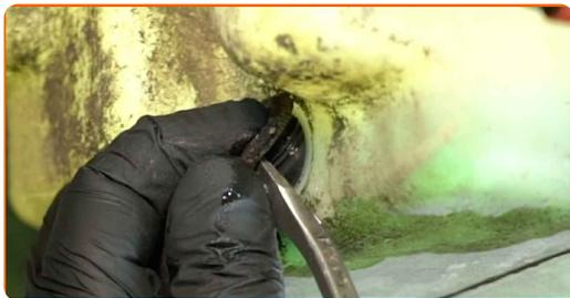
**18** Reinigen Sie das Befestigungsloch der Scheibenwaschpumpe. Verwenden Sie ein Allzweck-Reinigungsspray.
