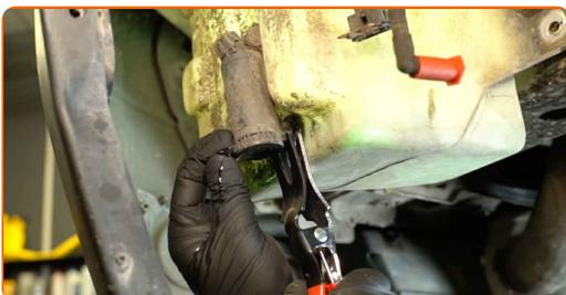
**17** Entfernen Sie die Dichtung der Scheibenwaschpumpe. Verwenden Sie einen Montagehebel.
