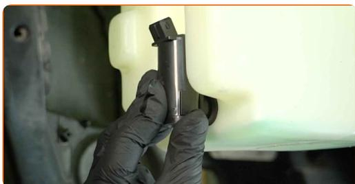
**21** Schließen Sie den Schlauch der Scheibenwaschanlage an.
