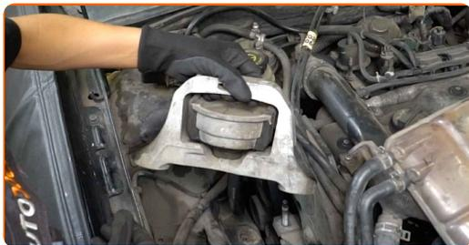
Austausch: Motorlager – FORD FOCUS Stufenheck (DFW). Tipp von AUTODOC-Experten:
