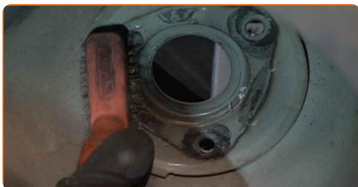
**52** Installieren Sie das Federbein am Radlauf.
