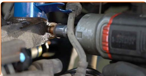
**59** Entfernen Sie den Träger unter dem Achsschenkel.
