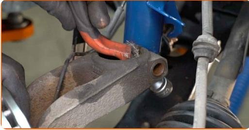
**55** Befestigen Sie das Dämpferbein auf dem Achsschenkel.
