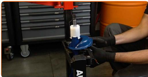
**43** Installieren Sie die Staubschutzmanschette und den Anschlagpuffer auf dem neuen Stoßdämpfer.
