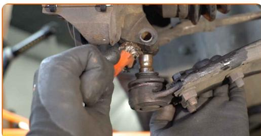
**63** Verbinden Sie das Kugelgelenk mit dem Achsschenkel.
