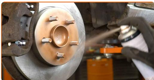
**17** Die Bremsscheibenoberfläche reinigen. Benutzen Sie einen Bremsenreiniger.
