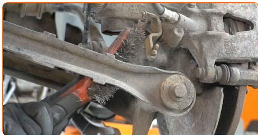
**10** Entfernen Sie das Handbremsseil. Verwenden Sie eine Kneifzange. Benutzen Sie ein Brecheisen.
