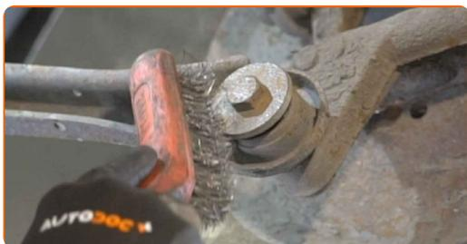
**25** Schrauben Sie die Befestigung heraus, die den Querlenker mit dem Hinterachsgelenk verbindet. Verwenden Sie Stecknuss Nr. 15. Verwenden Sie einen Ratschenschlüssel.
