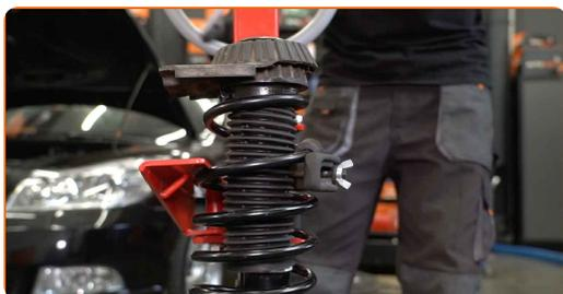
**48** Entfernen Sie das zusammengebaute Federbein.
