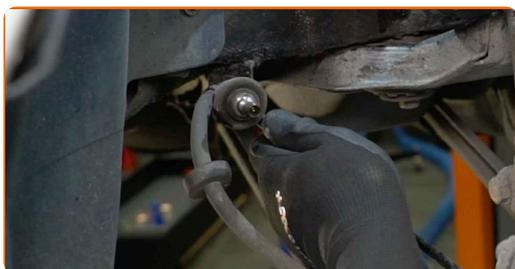
**9** Reinigen Sie die Befestigung des Handbremsseils. Benutzen Sie eine Drahtbürste. Benutzen Sie WD-40-Spray.
