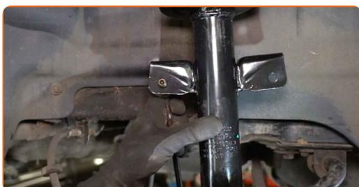
**74** Ziehen Sie die Befestigungselemente des Stabilenkers fest. Verwenden Sie Stecknuss Nr. 17. Verwenden Sie einen Ratschenschlüssel.
