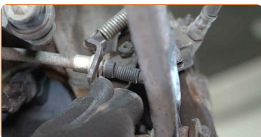
**72** Reinigen Sie die Montagesitze der Koppelstange. Benutzen Sie eine Drahtbürste. Benutzen Sie WD-40-Spray.
