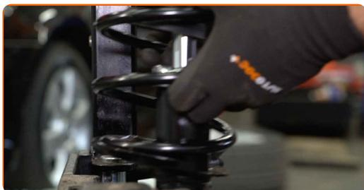
**49** Reinigen Sie die Anbringungssitze des Federbeins. Benutzen Sie eine Drahtbürste. Benutzen Sie WD-40-Spray.
