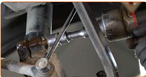
**23** Entfernen Sie die Befestigungsschraube.
