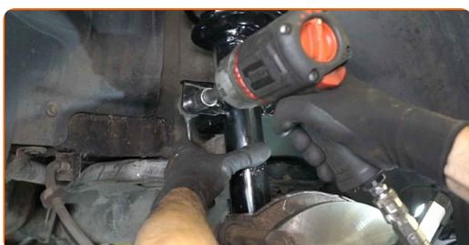
**75** Ziehen Sie das Befestigungselement an, das die Druckstange mit dem Federbein verbindet. Verwenden Sie Stecknuss Nr. 17. Verwenden Sie einen Drehmomentschlüssel. Ziehen Sie ihn mit 48 Nm Drehmoment fest.
